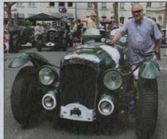
▲ Robert Lewis participe aux séances de roulage avec sa Lagonda 1939. Motorisée par un V12 de 6 l développant 300 ch, elle peut atteindre 200 km/h en vitesse de pointe.
